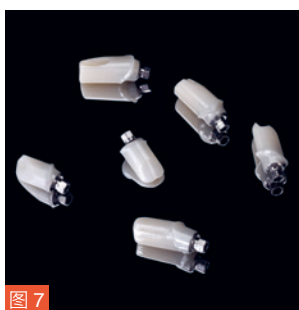
图 7: 切削出来的氧化锆一级结构 (在清洁及冷等离子体激活后) 与钛基底粘接。
