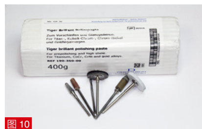
图 10：用于精加工和抛光的常用“技工室器具”（DENTAURUM, 德国）。
