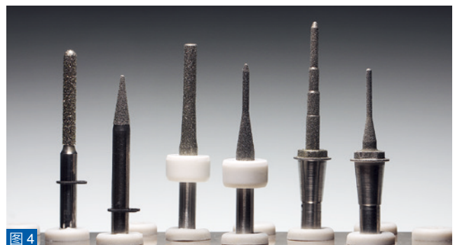
图 4: 用于湿加工模式的金刚石磨头的典型示例。
