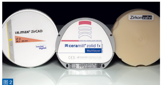
图 2: Ronde（盘状）材料块的典型形状。
