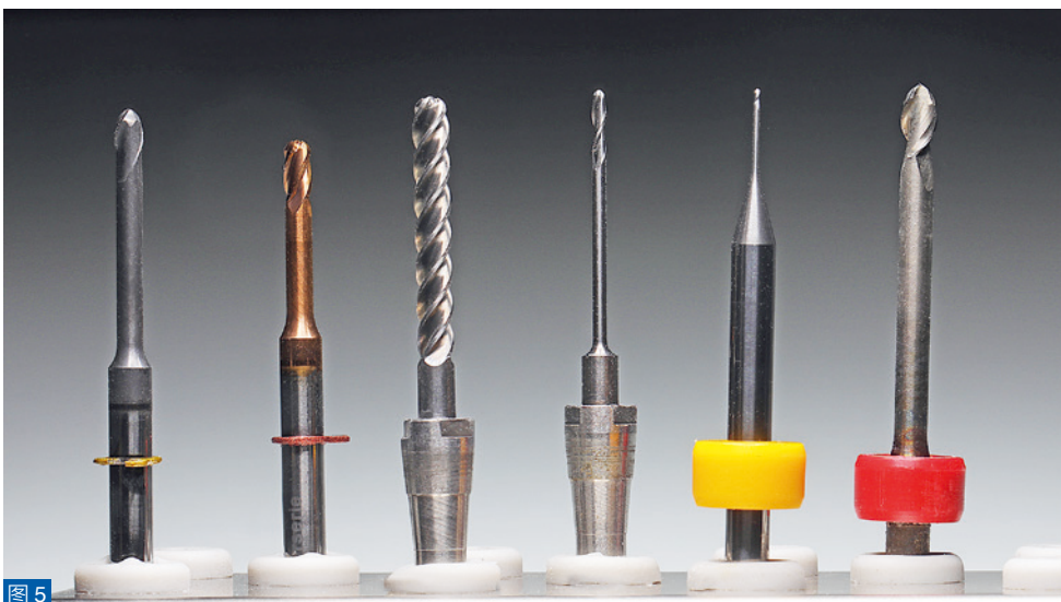
图5：硬质合金刀具用于加工硬度较低的工件。
