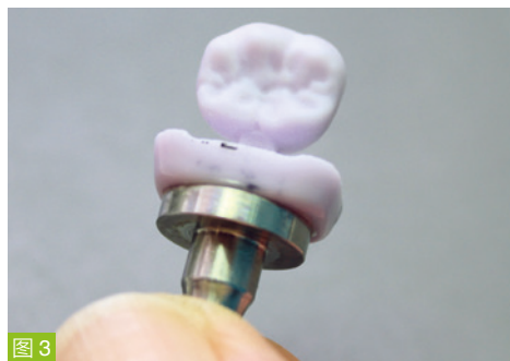
图 3: 切削完成的二硅酸锂冠，准备进行结晶烧结。ceraMotion® 也同样适用于氧化锆的个性化处理。
