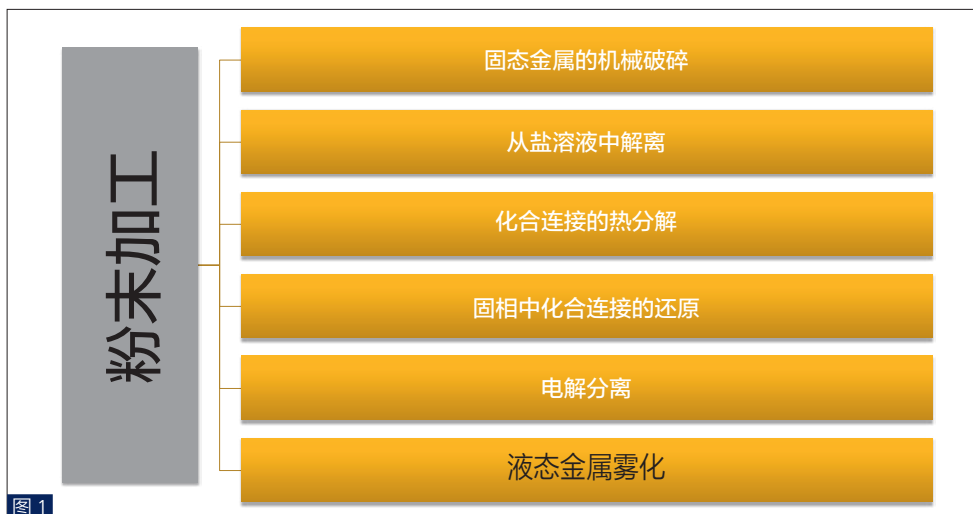
图 1: 金属粉末加工方式的示意图。
